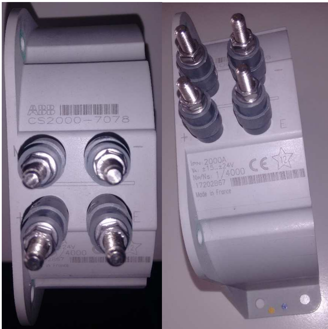
Bild 1: Typenschild des bisher eingesetzten Stromwandlers CS2000-7078
